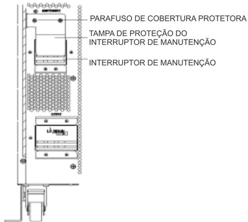
Fig.5-2 a tampa do disjuntor de bypass de manutenção
